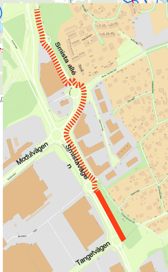
Figur 5. Föreslagen sträckning är markerad i rött för ny gång- och cykelbana längs Smistavägen. Den streckade linjen visar var bredning sker och i fylld linje visar var ny gång- och cykelbanan anläggs.
